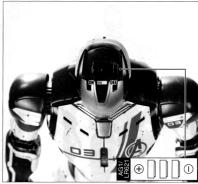
Detach the two pieces of battery covers on top of the head. ペッドバーツ上部のバッテリーカバー2個を取り 製品には電池(AG1 / LR621, 1.5V) 3つが付属します。画像のスイッチで「ON」「OFF」の切り換えができます。
