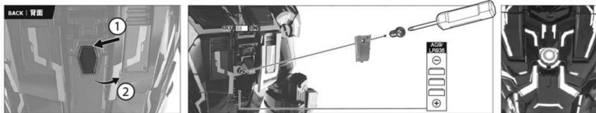
Push to lift up the indicated piece. 画像のパーツを軽く押し持ち上げ、バッテリーカバーのネジを露出させてください。 Unscrew and open the battery box to put in new batteries. Three batteries (AG9/LR936, 1.5V) are included. Activate the light-up function by turning the on/off switch. 製品には電池 (AG9/LR936, 1.5V) が3つ付属します。ドライバーを使用しバッテリーカバーを開け、電池を入れてください。画像のスイッチでON/OFFの切り換えができます。 松开螺絲打开電池箱蓋然後放入電池。盒內包含3顆電池 (AG9/LR936, 1.5V)，利用開關鍵啟動發光功能。
