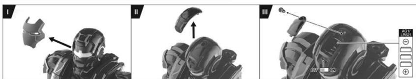
Detach the mask and take off the top part of helmet, unscrew and open the battery box to put in new batteries. Three batteries (AG1/LR621, 1.5V) are included. Activate the light-up function by turning the on/off switch. マスクを外し、ヘルメット頂部のパーツを外します。製品には電池 (AG1/LR621, 1.5V) が3つ付属します。ドライバーを使用しバッテリーカバーを開け、電池を入れてください。画像のスイッチでON/OFFの切り換えができます。
