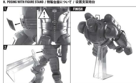
1) Detach the indicated armor plate and return the waist to shown position. 2) Attach the figure stand to the figure. 1) 画像のアーマーパーツを取り外し、ボディをまっすぐにしてください。2)画像を参考に、特製台座を取り付けてください。 1)卸下指定装甲并把腰部还原至图示位置。 2) 把支架地台安装至人偶。
