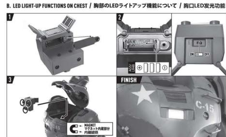
1) Unscrew and open the battery case. 2) Put in new batteries. Three batteries (AG5/LR48, 1.5V) are included. Activate the light-up function by toggling the on/off switch. 3) Open the cockpit and attach the battery case inside the figure. Complete as shown. 1)ドライバーを使用しバッテリーカバーを開け、電池を入れてください。2)製品には電池(AGS/LR48/LR754, 1.5V)が付属します。画像の スイッチで「ON」「OFF」の切り換えができます。3)コックビットのハッチを開き、電池ボックスを取り付けてください。完成です。 1)松开镙丝打开电池箱盖。 2) 放入电池。盒内包含了3颗电池(AG5/LR48, 1.5V)。利用开关键启动发光功能。 3) 如图示打开驾驶 舱并把电池箱装配至驾驶舱内。完成。
